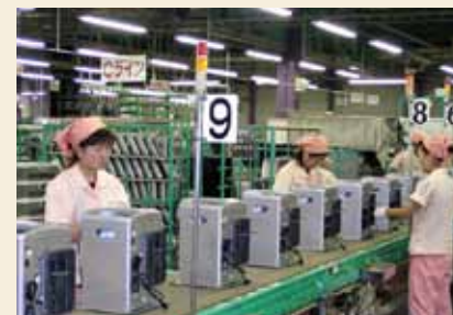
石油ファンヒーターの組立作業
