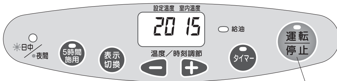
運転ランプ 運転/停止スイッチ
