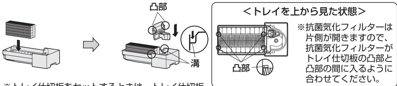
※トレイ仕切板をセットするときは、トレイ仕切板の凸部をトレイの溝に入れてください。
