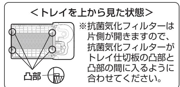
※トレイ仕切板をセットするときは、トレイ仕切板の凸部をトレイの溝に入れてください。
