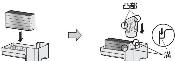
※トレイ仕切板をセットするときは、トレイ仕切板の凸部をトレイの溝に入れてください。
