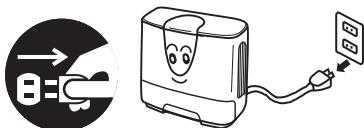
**電源プラグを抜くときは、電源コードを持たずに必ず先端の電源プラグを持って引き抜く**
