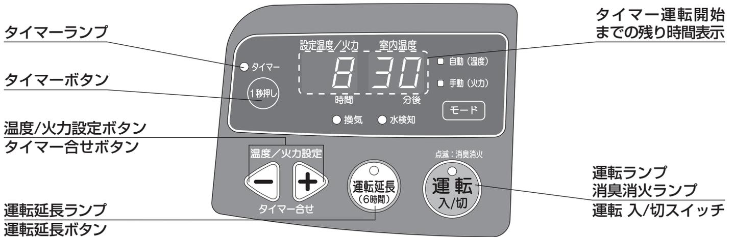
消し忘れによる万一の事故を防ぐため、運転開始後、6時間で自動消火します
