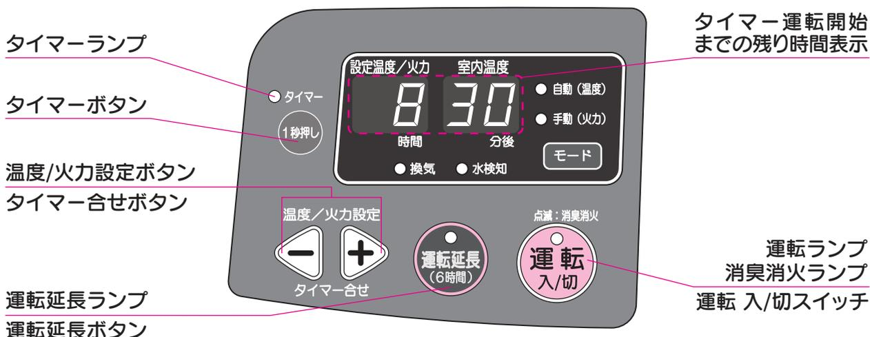
消し忘れによる万一の事故を防ぐため、運転開始後、6時間で自動消火します
