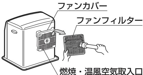
汚れがひどいときは、洗剤などを使って浸け置きし、水で洗い流してください。
