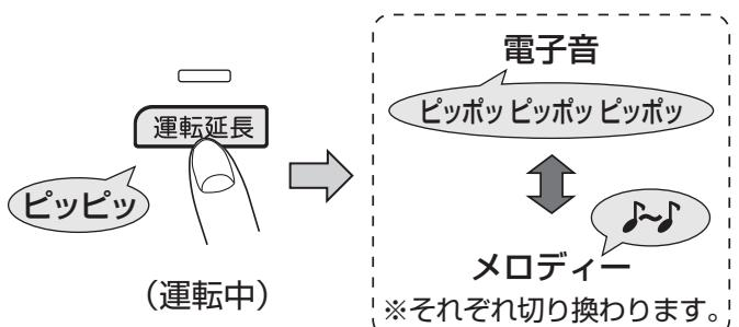
工場出荷時や電源プラグをコンセントから抜いたり、停電したときは電子音になります。
