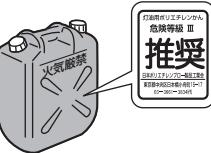
灯油は紫外線だけでなく温度でも変質するため、推奨マーク付の灯油用ポリタンクでも日なたには放置しないでください。
