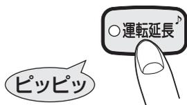
○ 燃焼残り時間のお知らせに関係なく、運転延長ボタンを押したときから、さらに3時間運転を継続します。
