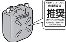
灯油は紫外線だけでなく温度でも変質するため、推奨マーク付の灯油用ポリタンクでも日なたには放置しないでください。変質灯油になります。
