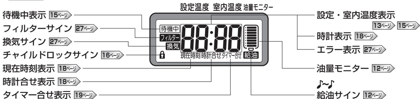
※表示部は、運転停止中でも時刻設定、時刻調節(現在時刻・タイマー運転開始時刻合わせ)、チャイルドロックのボタン操作により、バックライトが約10秒間点灯します。
