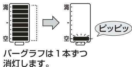
カートリッジタンクの灯油が少ないときに次の操作を行うと、バーグラフが点滅すると同時に電子音が鳴って、灯油が残り少ないとお知らせします。
