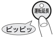
○ 燃焼残り時間のお知らせに関係なく、運転延長ボタンを押したときから、さらに3時間運転を継続します。
