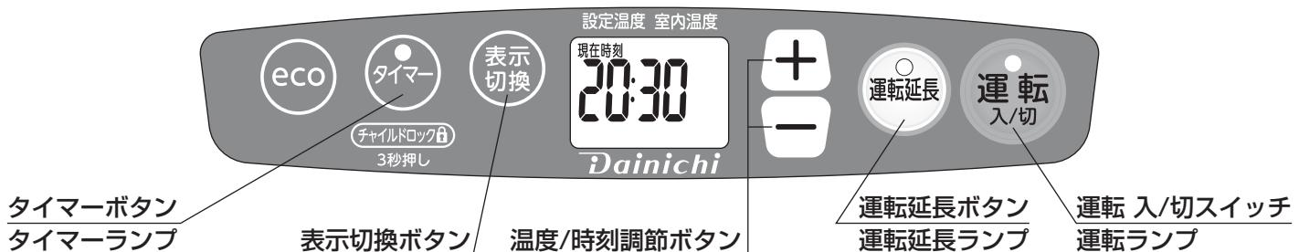
消し忘れによる万一の事故を防ぐため、運転開始後3時間で消し忘れ消火装置が作動し、自動消火します。
