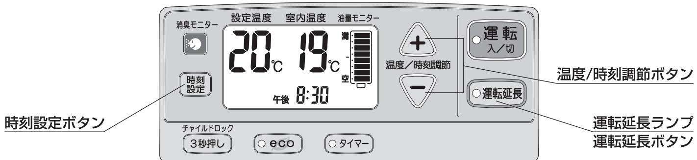
消し忘れによる万一の事故を防ぐため、運転開始後3時間で消し忘れ消火装置が作動し自動消火します。
