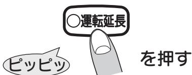
○運転延長ボタンは、燃焼残り時間のお知らせを行なったときに限らず、運転延長ボタンを押したときから、さらに3時間運転を継続します。
