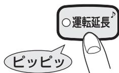
○燃焼残り時間のお知らせに関係なく、運転延長ボタンを押したときから、さらに3時間運転を継続します。
