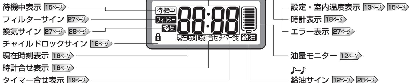
※表示部は、運転停止中でも時刻設定、時刻調節(現在時刻・タイマー運転開始時刻合わせ)、チャイルドロックのボタン操作により、バックライトが約10秒間点灯します。
