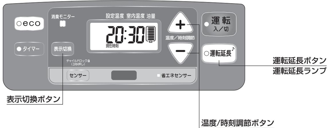
消し忘れによる万一の事故を防ぐため、運転開始後3時間で消し忘れ消火装置が作動し、自動消火します。
