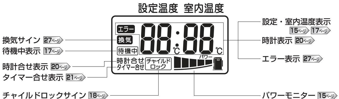
※表示部は、運転停止中でも表示切換、時刻調節(現在時刻・タイマー運転開始時刻合わせ)、チャイルドロックのボタン操作により、バックライトが約10秒間点灯します。
