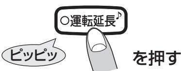
○燃焼残り時間のお知らせに関係なく、運転延長ボタンを押したときから、さらに3時間運転を継続します。
