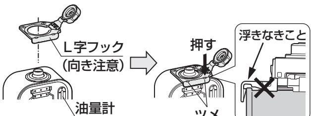
※取り付け向きが違うと故障・破損の原因となります。
