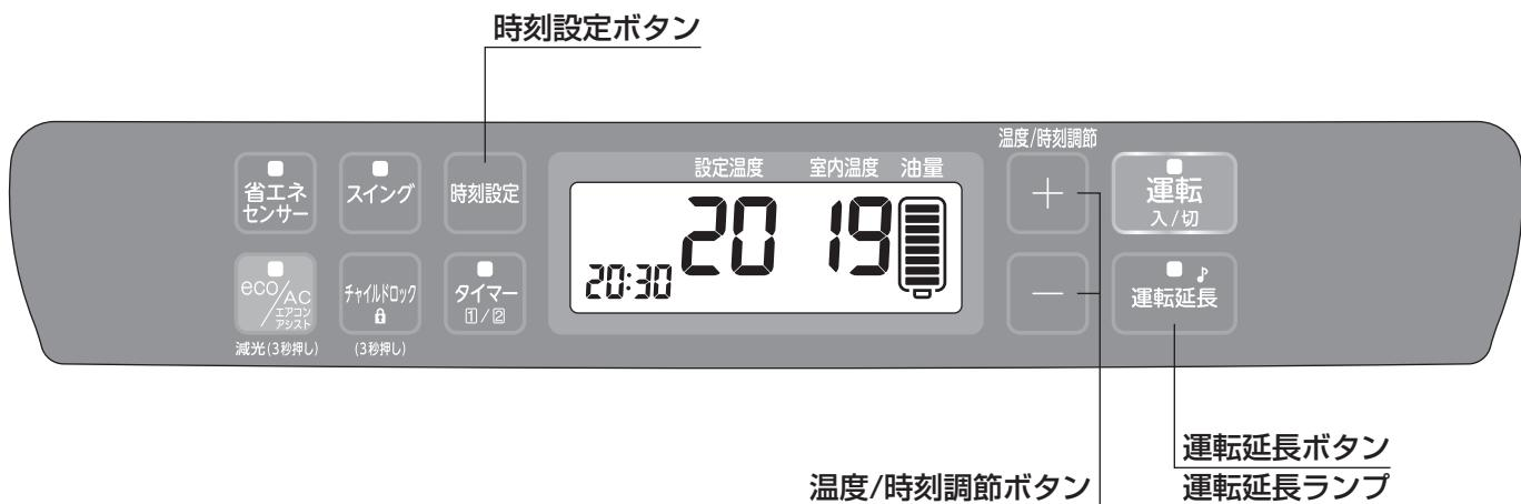
消し忘れによる万一の事故を防ぐため、運転開始後3時間で消し忘れ消火装置が作動し、自動消火します。
