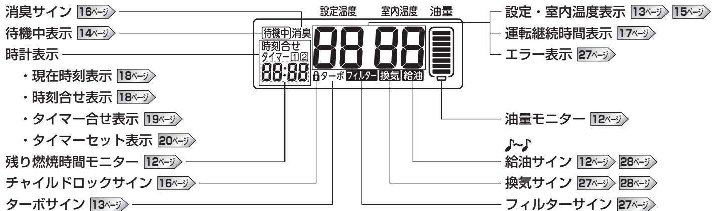
※表示部は、運転停止中でも時刻設定、時刻調節(現在時刻・タイマー運転開始時刻合わせ)、チャイルドロックのボタン操作により、バックライトが約10秒間点灯します。
