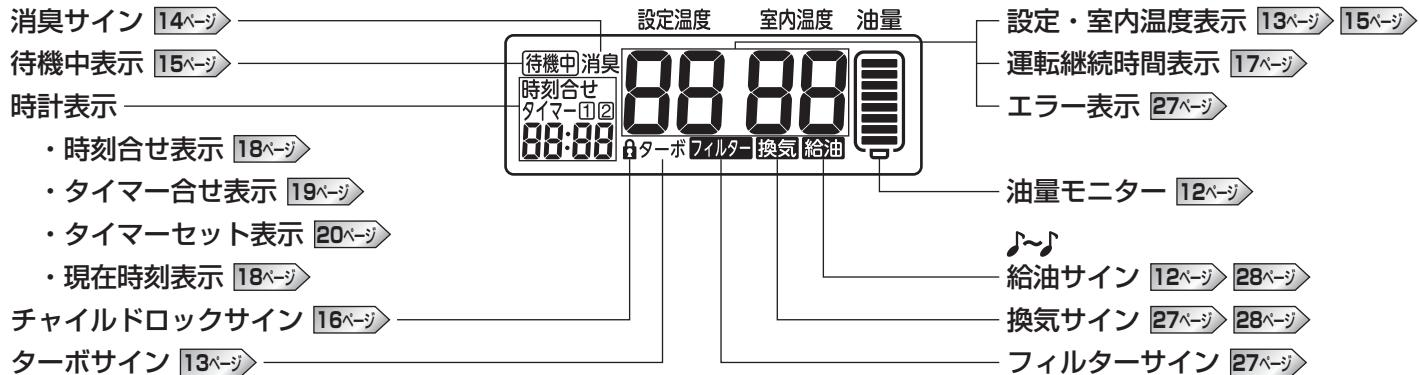
※表示部は、運転停止中でも時刻設定、時刻調節(現在時刻・タイマー運転開始時刻合わせ)、チャイルドロックのボタン操作により、バックライトが約10秒間点灯します。
