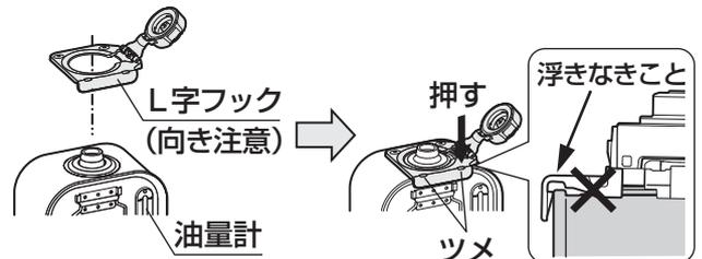
※取り付け向きが違くと故障・破損の原因となります。
