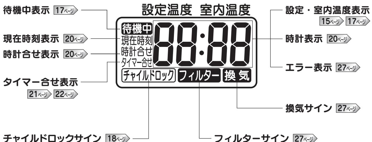
※表示部は、運転停止中でも表示切換、時刻調節(現在時刻・タイマー運転開始時刻合わせ)、チャイルドロックのボタン操作により、バックライトが約10秒間点灯します。
