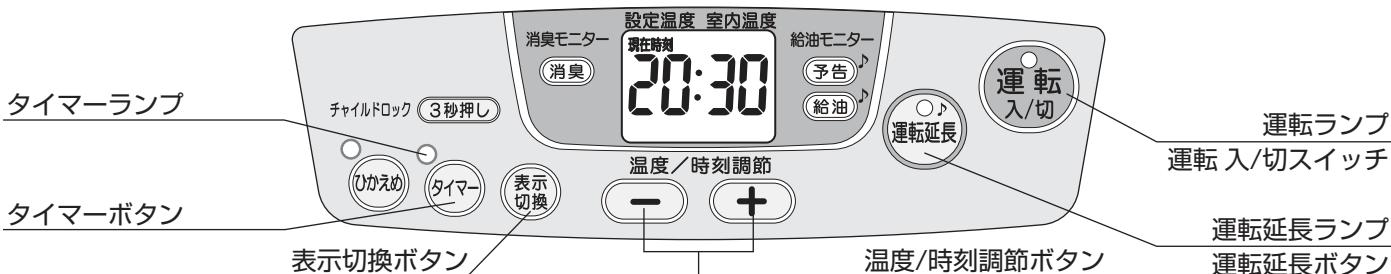
消し忘れによる万一の事故を防ぐため、運転開始後、3時間で自動消火します
