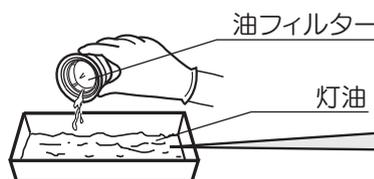
○油フィルターは、きれいな灯油ですすぎ洗いし、ごみなどを取り除き、布などで灯油をふき取ったあと、日陰に置いてよく乾燥させてください。油フィルターに水分が残っていると、灯油が落ちず、給油ランプが点滅します。
