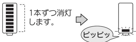
残り約1時間の燃焼が行えないときに次の操作を行うと、バーグラフが点滅すると同時に電子音が鳴って、灯油が残り少ないことをお知らせします。
