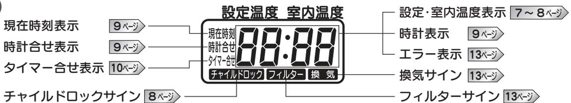
※表示部は、運転停止中でも表示切換、時刻調節(現在時刻・タイマー運転開始時刻合わせ)、
