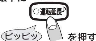
○運転延長ボタンは燃焼残り時間のお知らせを行ったときに限らず、運転延長ボタンを押したときから、さらに約3時間運転を継続します。
