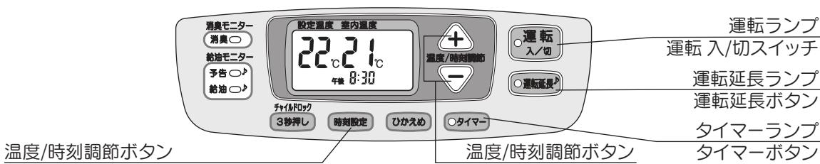
消し忘れによる万一の事故を防ぐため、運転開始後約3時間で自動消火します。
