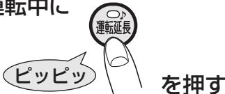
○燃焼残り時間のお知らせに関係なく、運転延長ボタンを押したときから、さらに3時間運転を継続します。
