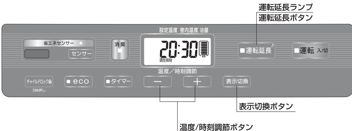
消し忘れによる万一の事故を防ぐため、運転開始後3時間で消し忘れ消火装置が作動し、自動消火します。
