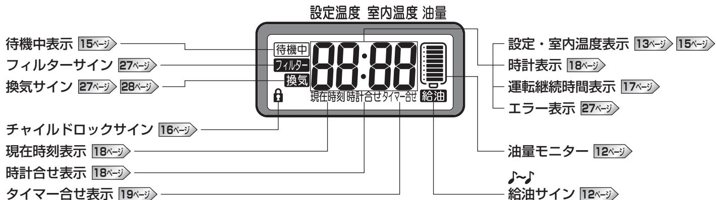
※表示部は、運転停止中でも時刻設定、時刻調節(現在時刻・タイマー運転開始時刻合わせ)、チャイルドロックのボタン操作により、バックライトが約10秒間点灯します。
