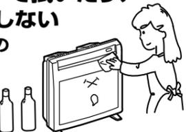
可燃性ガスの発生するもの(スプレー・ベンジン・シンナー)を使用する部屋では使用しない
