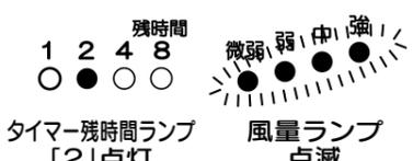
残時間<br>1 2 4 8<br>○ ● ○ ○<br>タイマー残時間ランプ「2」点灯<br>風量ランプ点滅 | ネットフィルターが正しくセットされていない | ネットフィルターを正しくセットする (13ページ参照)                 |
