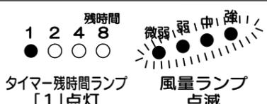
残時間<br>1 2 4 8<br>● ○ ○ ○<br>タイマー残時間ランプ「1」点灯<br>風量ランプ点滅 | 吸気グリルが正しくセットされていない    | 吸気グリルを正しくセットする (13ページ参照)                    |
