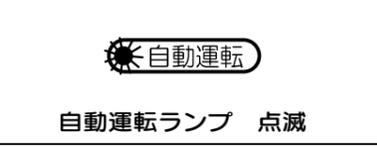
残時間<br>1 2 4 8<br>○ ● ○ ○<br>タイマー残時間ランプ「2」点灯<br>風量ランプ点滅 | 放電ユニットが十分乾燥していない      | 放電ユニットを取り出し、乾燥させてから運転入/切スイッチを押し直す (15ページ参照) |
