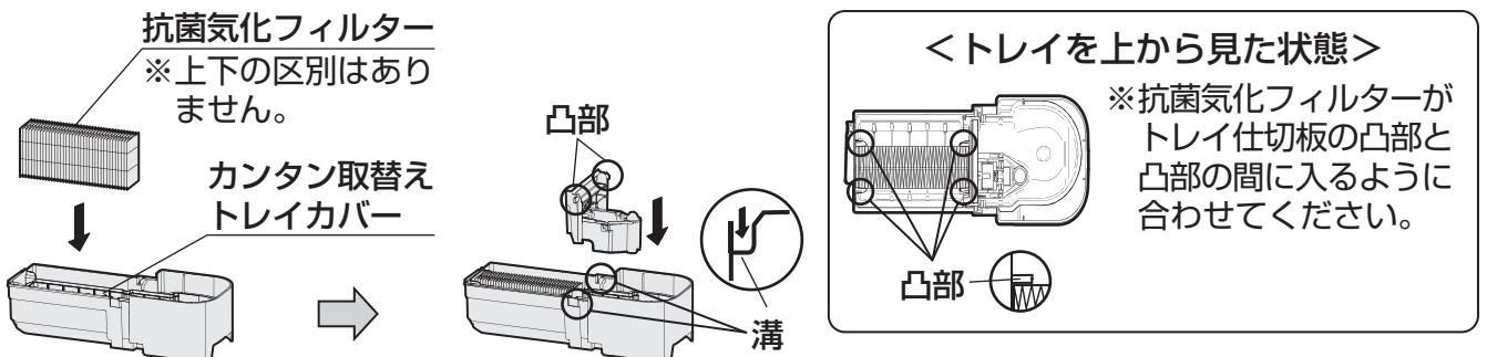
※トレイ仕切板をセットするときは、トレイ仕切板の凸部をトレイの溝に入れてください。
