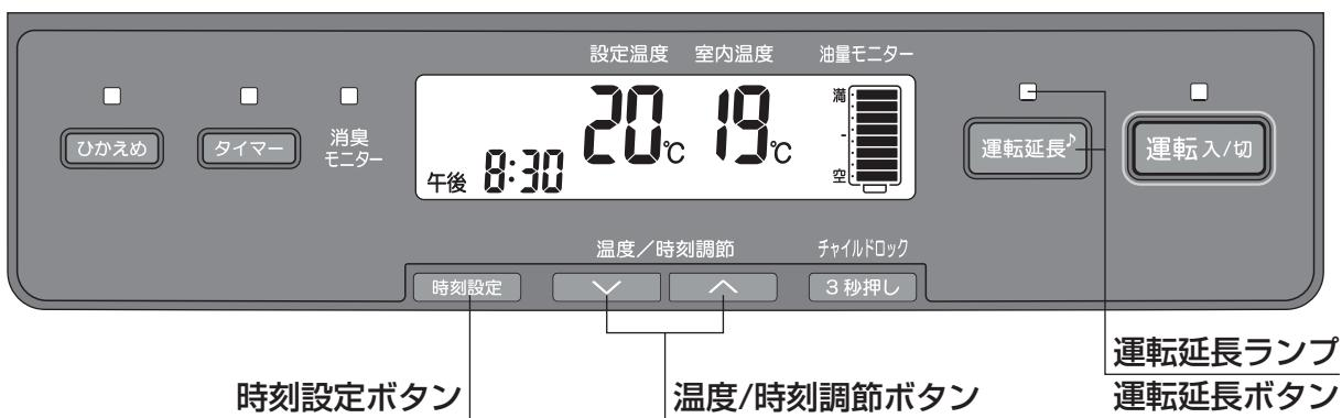
消し忘れによる万一の事故を防ぐため、運転開始後、3時間で自動消火します
