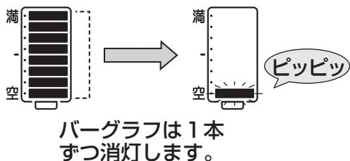
カートリッジタンクの灯油が少ないときに次の操作を行うと、バーグラフが点滅すると同時に電子音が鳴って、灯油が残り少ないことをお知らせします。
