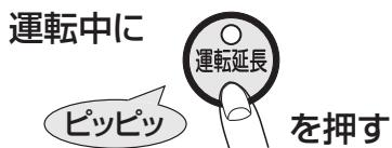
○燃焼残り時間のお知らせに関係なく、運転延長ボタンを押したときから、さらに3時間運転を継続します。
