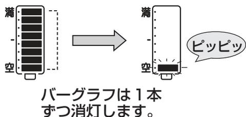
残り約1時間の燃焼が行えないときに次の操作を行うと、バーグラフが点滅すると同時に電子音が鳴って、灯油が残り少ないことをお知らせします。
