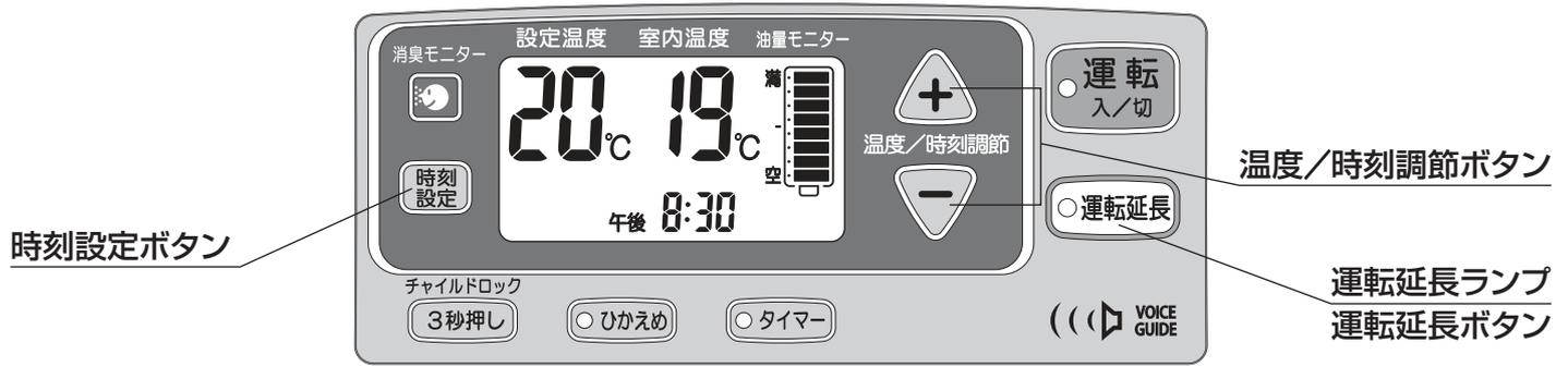
消し忘れによる万一の事故を防ぐため、運転開始後、3時間で自動消火します
