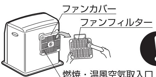
汚れがひどいときは、洗剤などを使って浸け置きし、水で洗い流してください。
