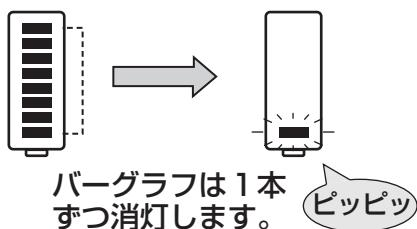
カートリッジタンクの灯油が少ないときに次の操作を行うと、バーグラフが点滅すると同時に電子音が鳴って、灯油が残り少ないとお知らせします。
