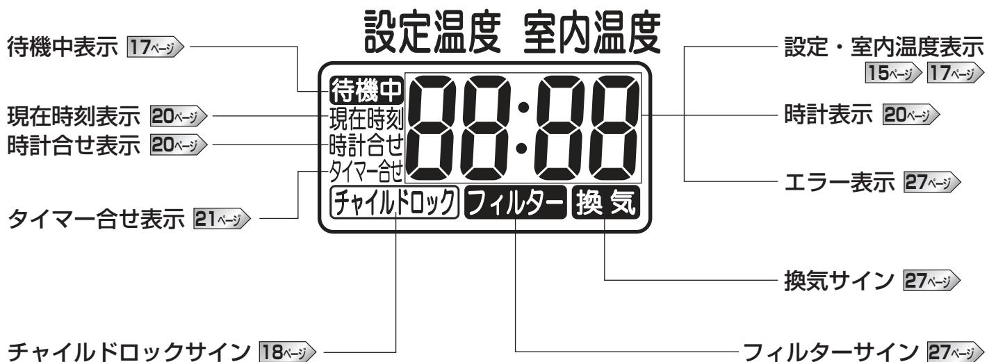
※表示部は、運転停止中でも表示切換、時刻調節(現在時刻・タイマー運転開始時刻合わせ)、チャイルドロックのボタン操作により、バックライトが約10秒間点灯します。
