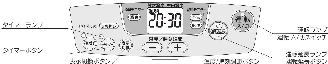
消し忘れによる万一の事故を防ぐため、運転開始後、3時間で自動消火します
