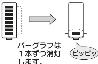
残り約1時間の燃焼が行えないときに次の操作を行うと、バーグラフが点滅すると同時に電子音が鳴って、灯油が残り少ないことをお知らせします。
