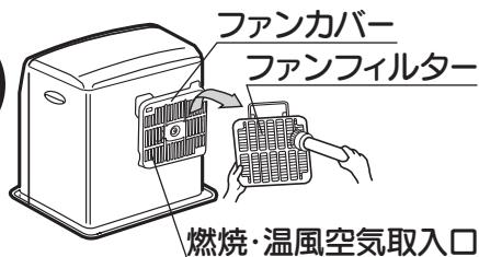
汚れがひどいときは、洗剤などを使って浸け置きし、水で洗い流してください。
