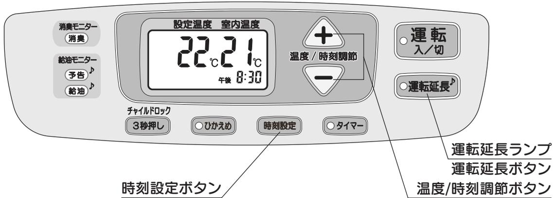
消し忘れによる万一の事故を防ぐため、運転開始後、約3時間で自動消火します
