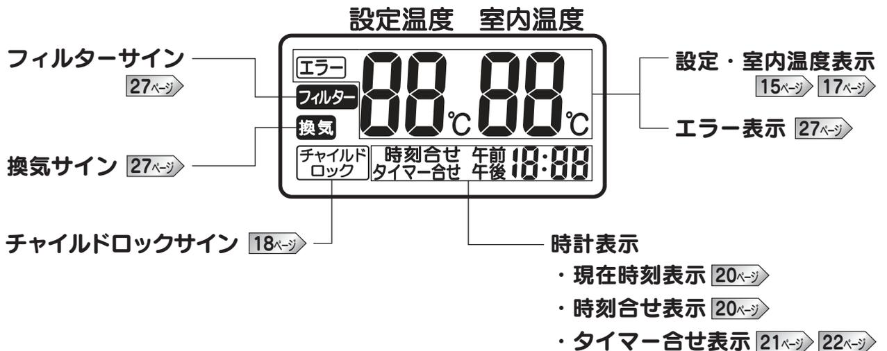
※表示部は、運転停止中でも時刻設定、時刻調節(現在時刻・タイマー運転開始時刻合わせ)、チャイルドロックのボタン操作により、バックライトが約10秒間点灯します。
