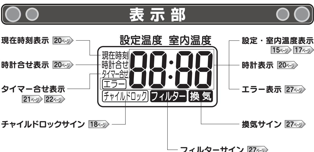
※表示部は、運転停止中でも表示切換、時刻調節(現在時刻・タイマー運転開始時刻合わせ)、チャイルドロックのボタン操作により、バックライトが約10秒間点灯します。
