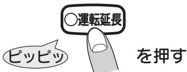
○運転延長ボタンは燃焼残り時間のお知らせを行ったときに限らず、運転延長ボタンを押したときから、さらに約3時間運転を継続します。
