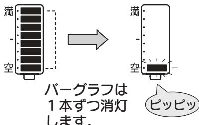
残り約1時間の燃焼が行えないときに次の操作を行うと、バーグラフが点滅すると同時に電子音が鳴って、灯油が残り少ないことをお知らせします。
