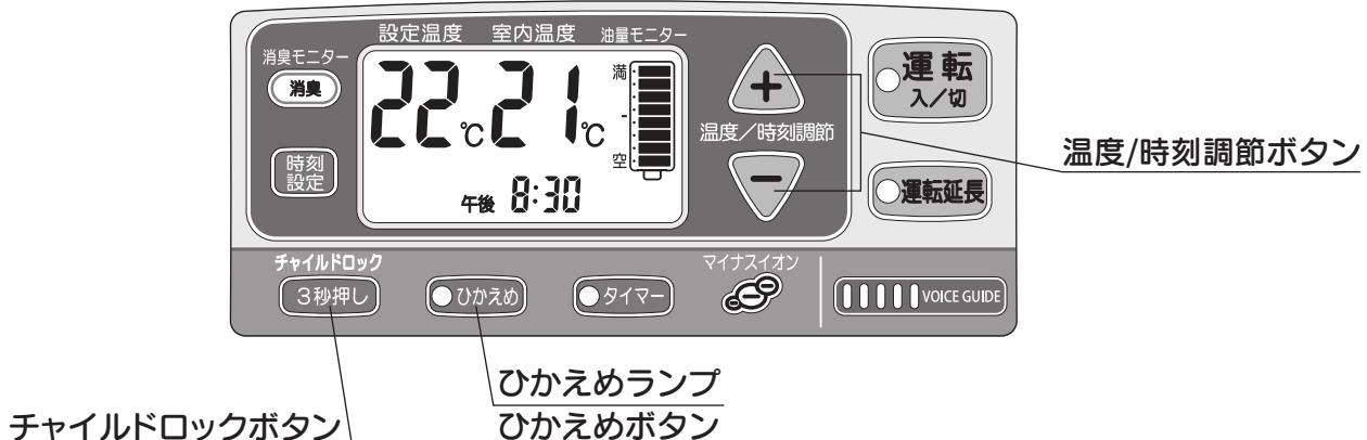
**温度/時刻調節ボタン**を押し、設定温度を調節します。
