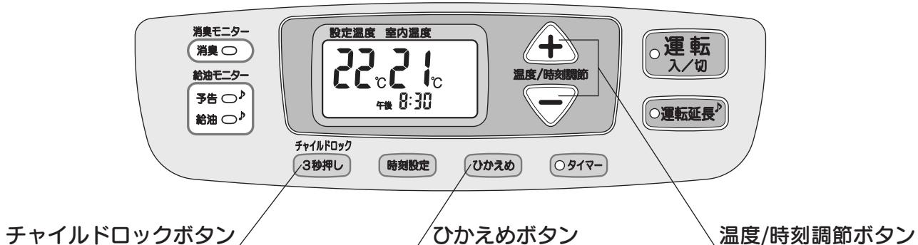
温度/時刻調節ボタンを押し、設定温度を調節します。
