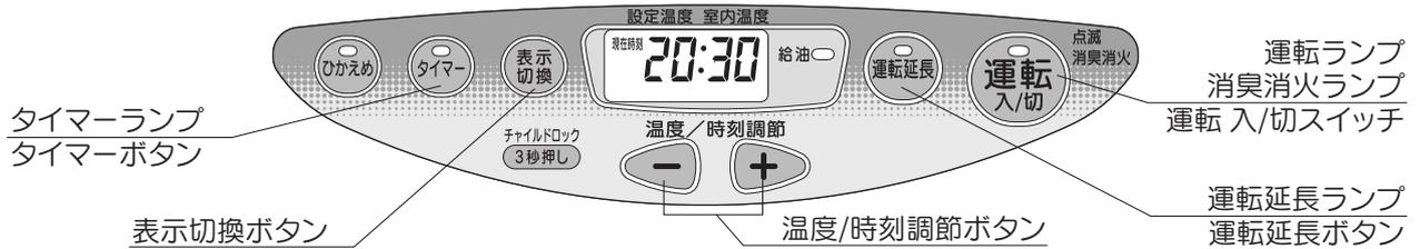
消し忘れによる万一の事故を防ぐため、運転開始後約3時間で自動消火します。
