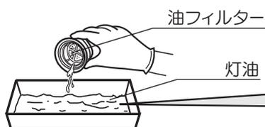
油フィルターはきれいな灯油ですすぎ洗いし、ごみなどを取りのぞき、布などで灯油を拭き取ったあと、日陰に置いてよく乾燥させてください。油フィルターに水分が残っていると、灯油が落ちず、給油ランプが点滅します。
