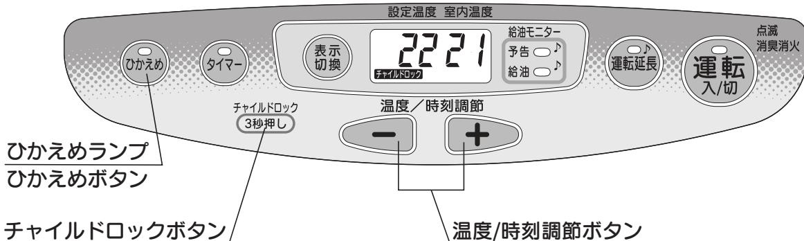
**温度/時刻調節ボタンを押し、設定温度を調節します。**
