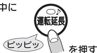
○運転延長ボタンは燃焼残り時間のお知らせを行ったときに限らず、運転延長ボタンを押したときから、さらに約3時間運転を継続します。
