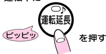
○ 運転延長ボタンは燃焼残り時間のお知らせを行ったときに限らず、運転延長ボタンを押したときから、さらに約3時間運転を継続します。
