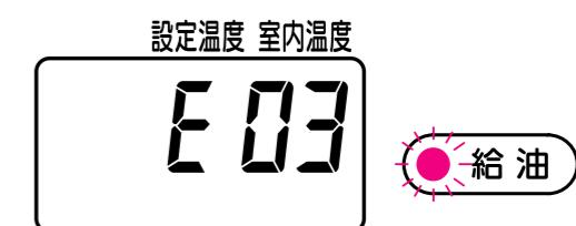
**3** 給油を行い、運転/停止スイッチを押すと、運転を再開します
