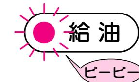
**2** そのまま使用しつづけると約45分後（設定温度が“H1”的ときは約10分後）に灯油がなくなり、「E03」を表示して自動消火します
