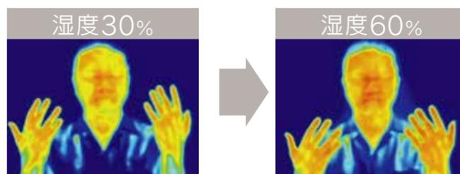
【試験条件】試験機種：HD-PC2400G / 当社環境試験室 (約3.5畳) を室内温度25℃とし、湿度30%の場合と湿度60%に到達した場合の比較。
