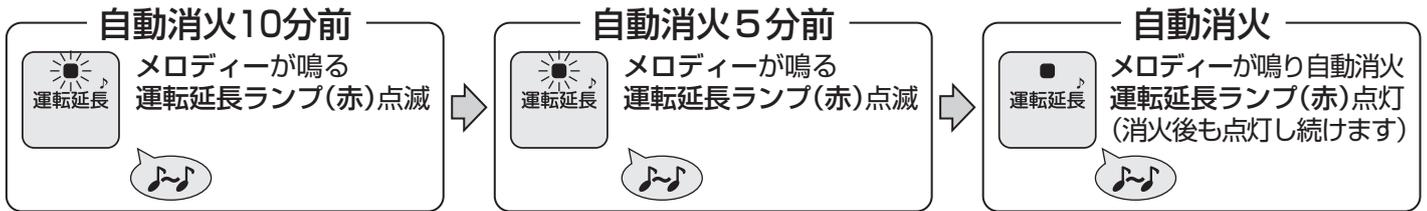
※自動消火後に運転入/切スイッチを押すと点灯を解除できますが、再度、運転が開始されます。
