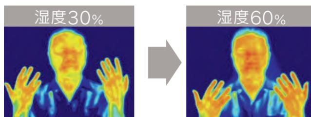
[試験条件]試験機種:HD-PC2400G/当社環境試験室(約3.5畳)を室内温度25℃とし、湿度30%の場合と湿度60%に到達した場合の比較。
