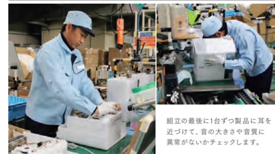
組立の最後に1台ずつ製品に耳を近づけて、音の大きさや音質に異常がないかチェックします。
